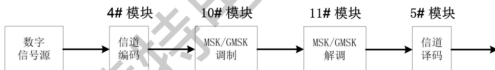
GSM通信系统实验原理框图
