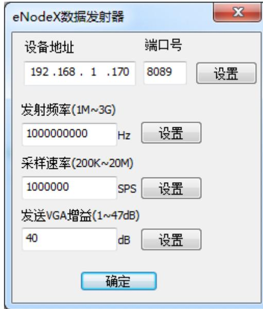
注: eNodeX-CX 发射器的可设置参数中, 发射频率、采样速率以及发送VGA增益均与实验无关, 实验过程中只要参数默认值处于可调范围内均不用设置。
