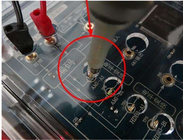
(3) 对于台阶插座，可用实验导线连接台阶座与示波器的探勾。
