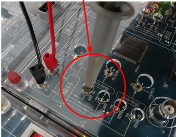
(2) 或将示波器探头夹取下来，直接用探头夹接触测试点，观察波形时需要注意固定好示波器探头；
