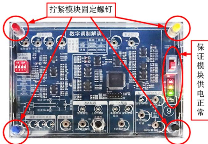
2、**实验连线：**准备工作做完后，需要进行连线操作时，请先将单元模块断电，捏住插头的头部进行插拔，切勿直接拽线。
