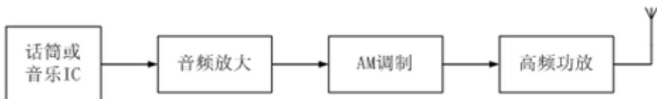
图 20-1 中波调幅发射机
